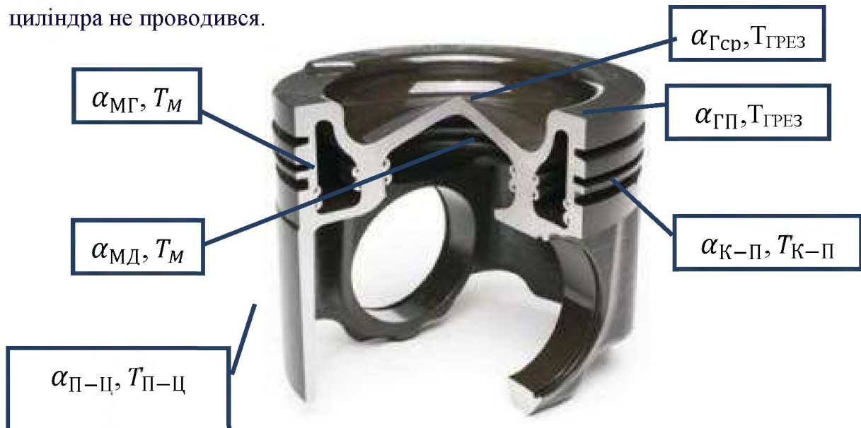
Рис. 7. Граничні умови для різних зон поршня МоноХотр :
